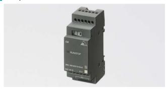
Коммуникационный модуль LOGO! СМ выполняет функции ведомого устройства AS-Interface и поддерживает 4 виртуальных дискретных входа и 4 виртуальных дискретных выхода. Он и способен передавать информацию о состоянии 4 дискретных входов LOGO! ведущему устройству AS-Interface, а также принимать от него 4 управляющих дискретных сигнала
