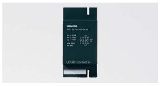
Модули LOGO! Contact предназначены для бесшумной коммутации цепей трехфазного переменного тока напряжением до 400 В с активной нагрузкой до 20 А или с асинхронными электродвигателями мощностью до 4 кВт. LOGO! Contact не имеют интерфейса для подключения к внутренней шине логического модуля LOGO! Управление их работой осуществляется через дискретные выходы логического модуля или модуля расширения DM8/ DM16.
