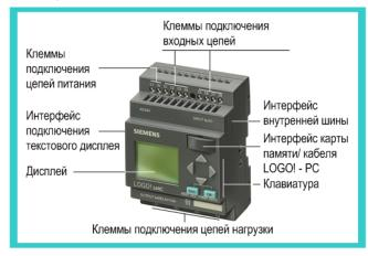
Логические модули LOGO! выпускаются в пластиковых корпусах размерами 72 х 90 х 55 мм и имеют степень защиты IP 20. Каждый модуль оснащен:
