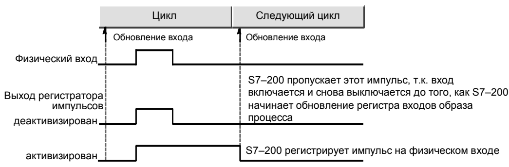
Рис. 4-25. Функционирование S7-200 с активизированным и деактивизированным регистратором импульсов
