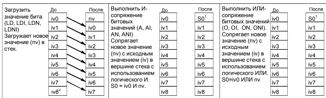
Рис. 6-2. Принцип действия контактов.
