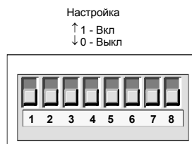
Рис. А–21. Двухпозиционные переключатели для модуля EM 231 RTD
