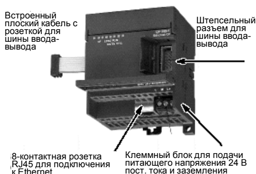
Рис. А–37. Подключение модуля Ethernet (CP 243-1)
