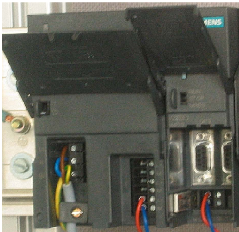
Рисунок 5-1 Электрический монтаж блока питания и CPU
