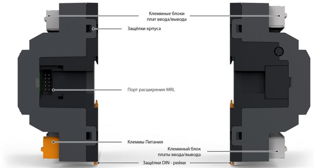
Рис. 3 - Модуль ввода/вывода. Виды сбоку
