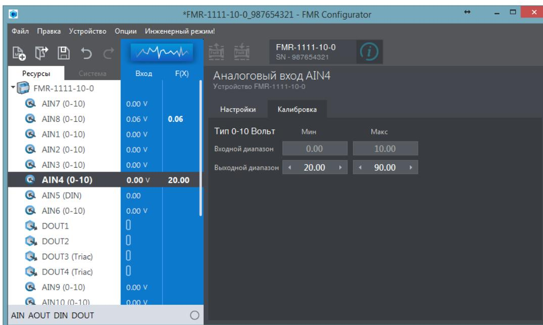
Рис. 37 – Конфигурация масштабирования и сдвига измеренной величины
