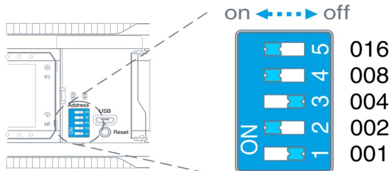
Рис. 30 - Задание адреса модуля в сети ModBus
