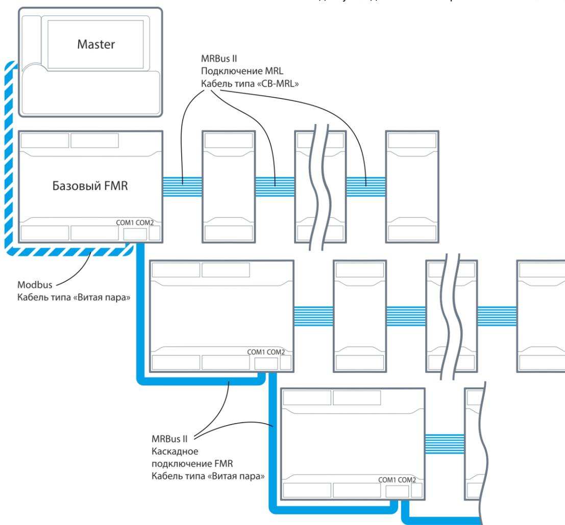
Рис. 23 – Система FMR в составе Master-контроллера
