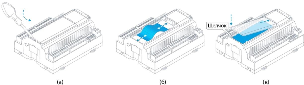
Рис. 9 – Извлечение и установка маркировочного вкладыша
