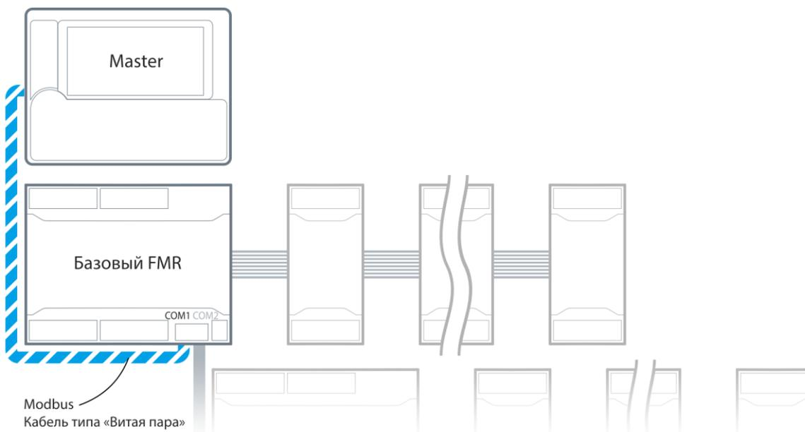
Рис. 26 - Подключение модуля FMR к контроллеру
