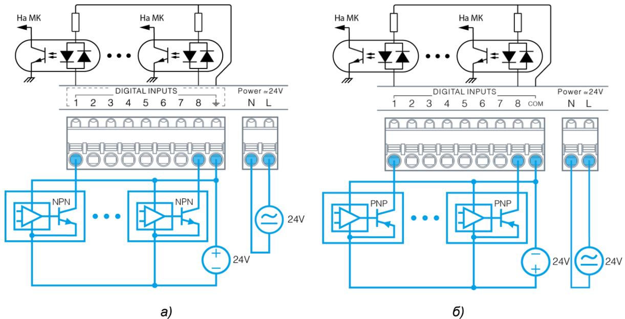
Рис. 14 – Подключение полупроводниковых датчиков с выходами типа «открытый коллектор»
