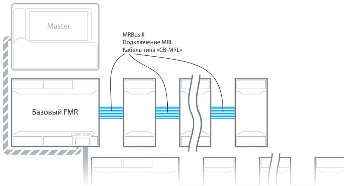
Рис. 25 - Подключение модулей MRL к FMR
