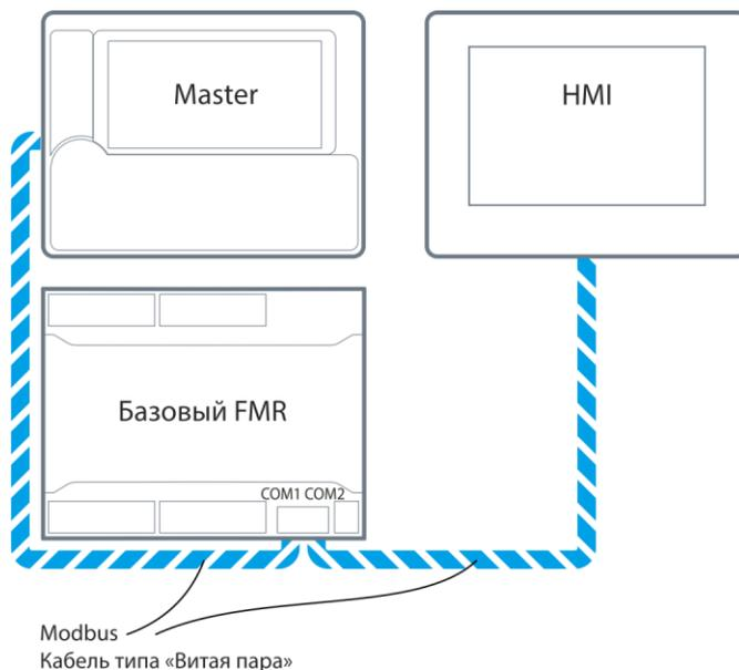
Рис. 27 – Подключение модуля FMR к двум Master - устройствам
