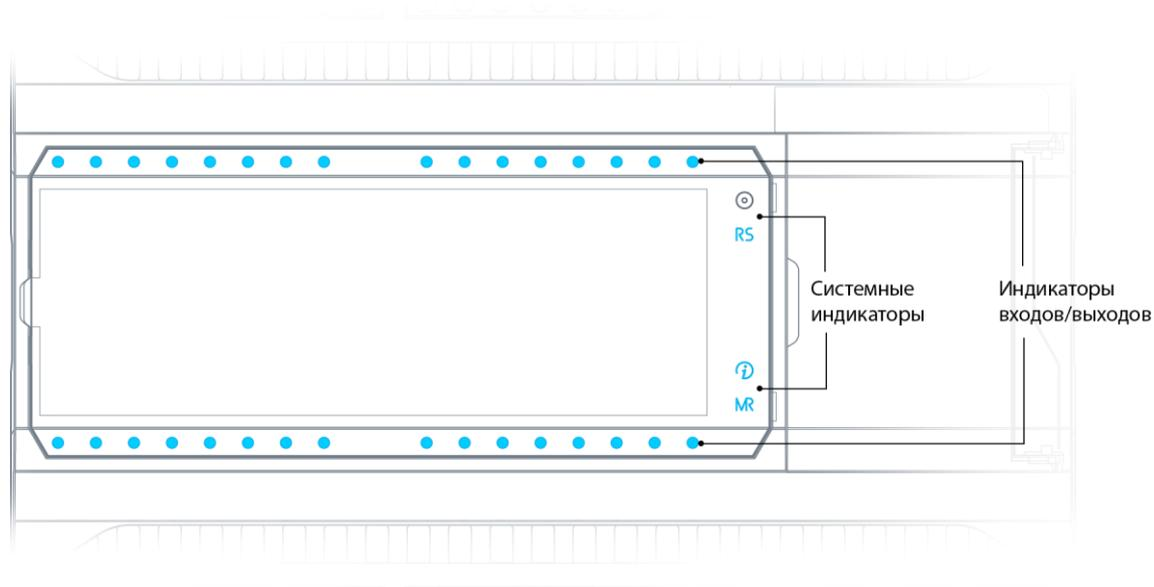
Рис. 11 — Расположение индикаторов на корпусе прибора
