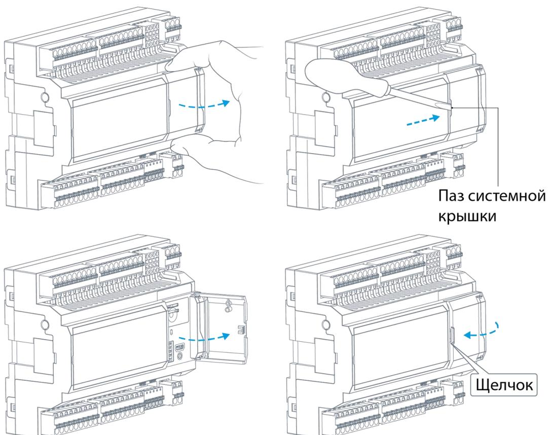
Рис. 8 – Открывание и закрывание крышки системного отсека
