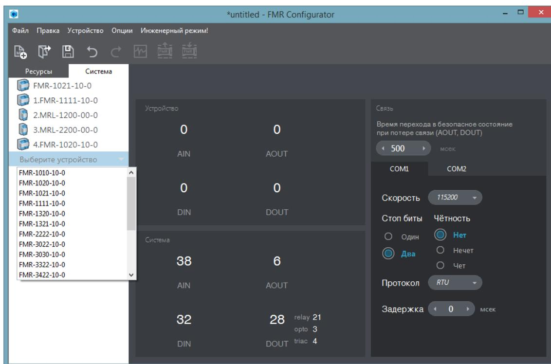
Рис. 33 – Создание и редактирование системы FMR
