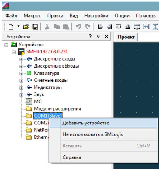
Рис. 41 – Добавление Slave устройства в SMLogix
