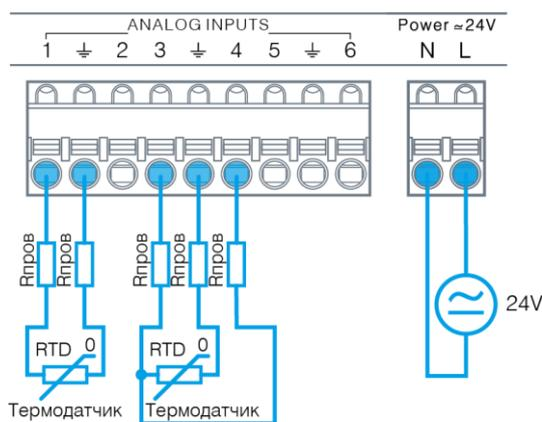
Рис. 21 - Двухпроводное и трехпроводное подключение резистивных датчиков.
