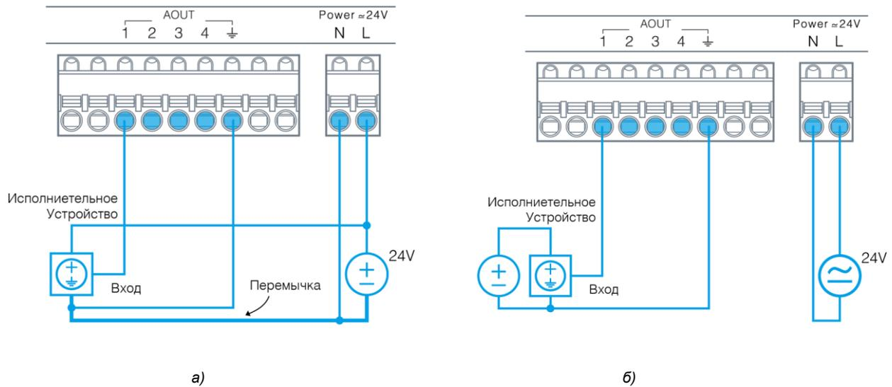
Рис. 22 - Подключение внешних устройств с питанием от одного источника (а); от отдельных источников (б)
