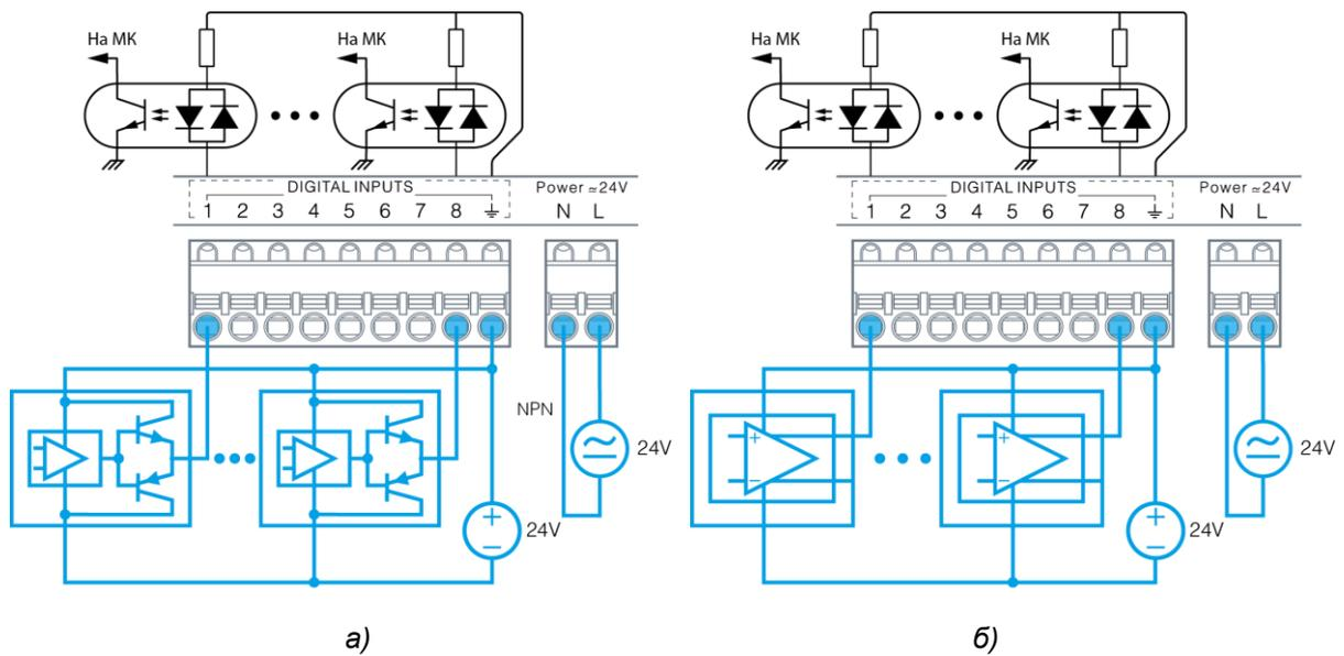
Рис. 15 – Подключение полупроводниковых датчиков с двухтактным типом выхода (а);
