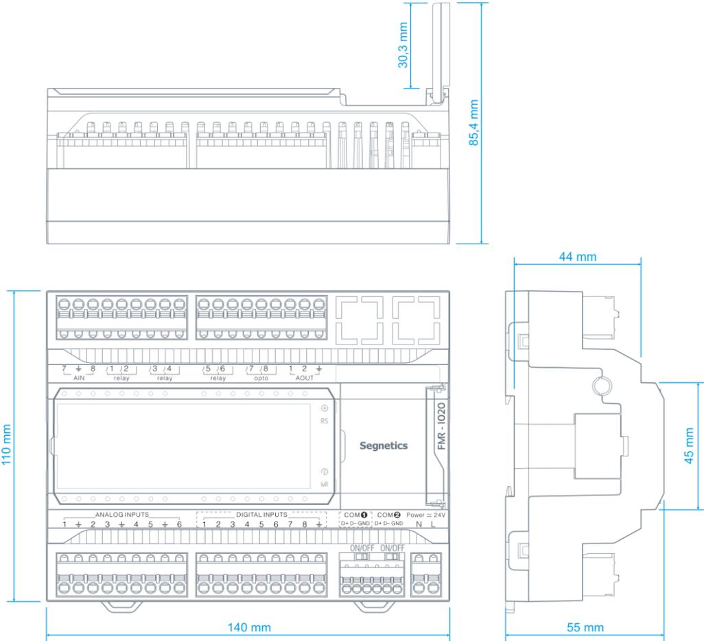
Рис. 4 - Габаритные и установочные размеры модуля
