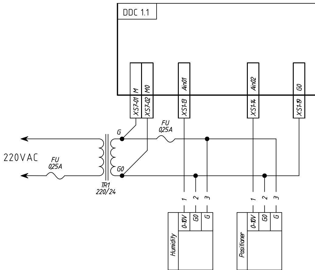
Не допускается объединение клеммы М0 и клеммы Г0 непосредственно на контроллере!
