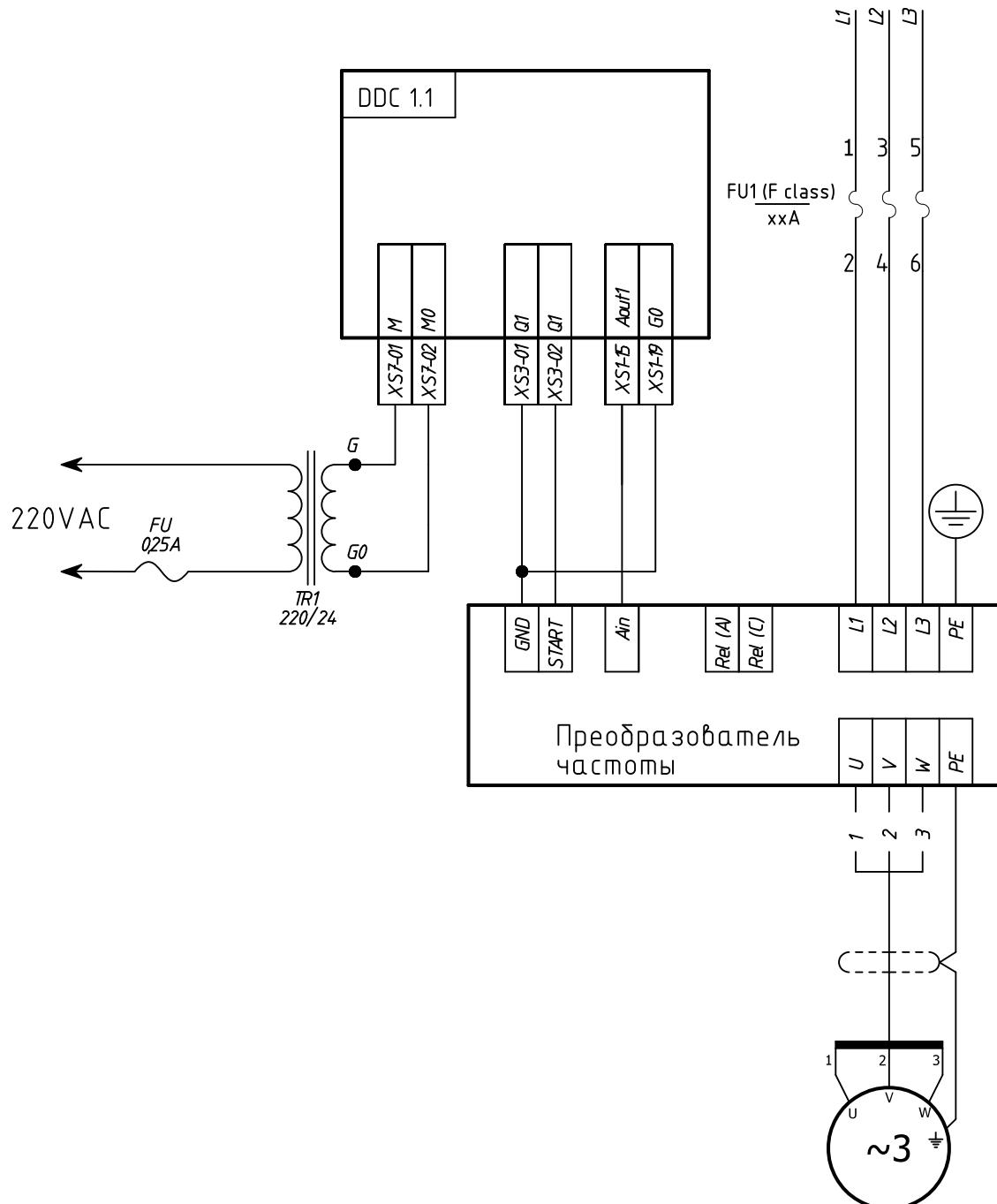
**Подключение преобразователя частоты.**
