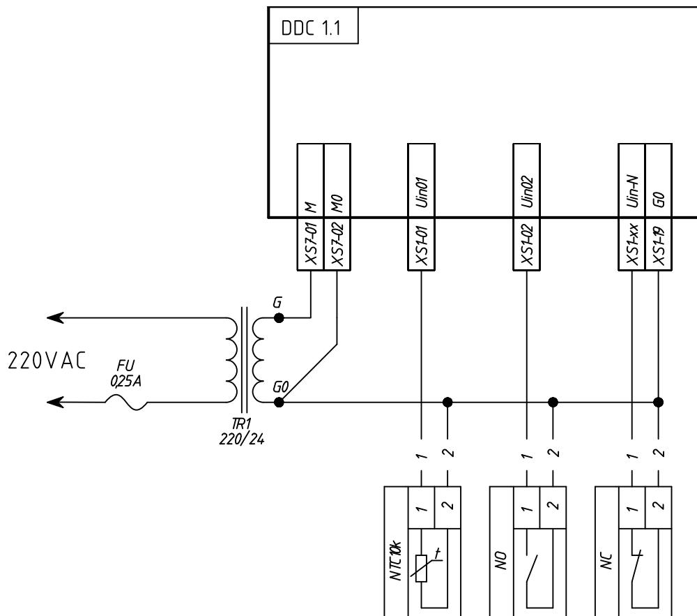
Не допускается объединение клеммы МО и клеммы GO непосредственно на контроллере!
