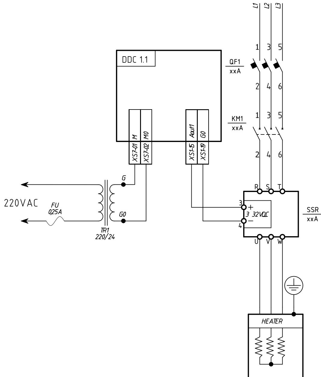
Выходы Aout1 – Aout4 могут быть настроены как для работы в режиме ШИМ, так и в пропорциональном режиме.
